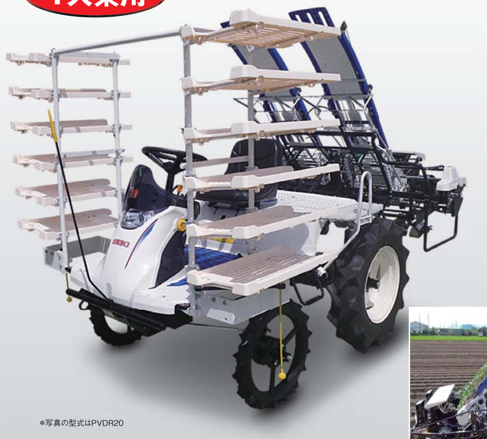
▲上写真の型式はPVDR20-RSで、かん水装置(オプション)を装備しています
