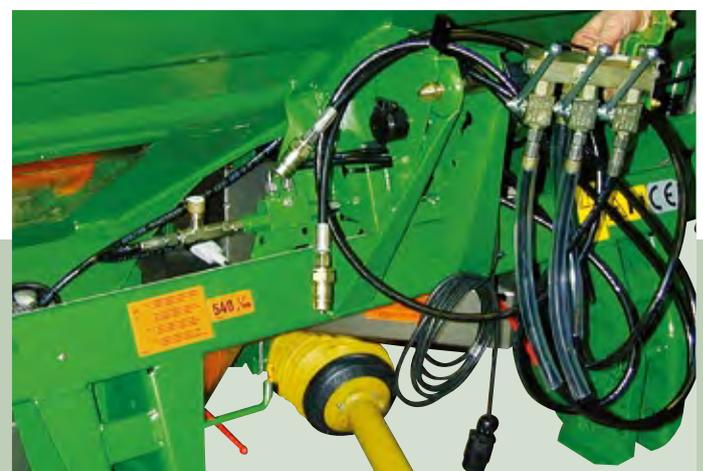
十分な油圧設備がないトラクターでも簡素な2-ウェイまたは3-ウェイ切替バルブを使用することができます。(オプション)
