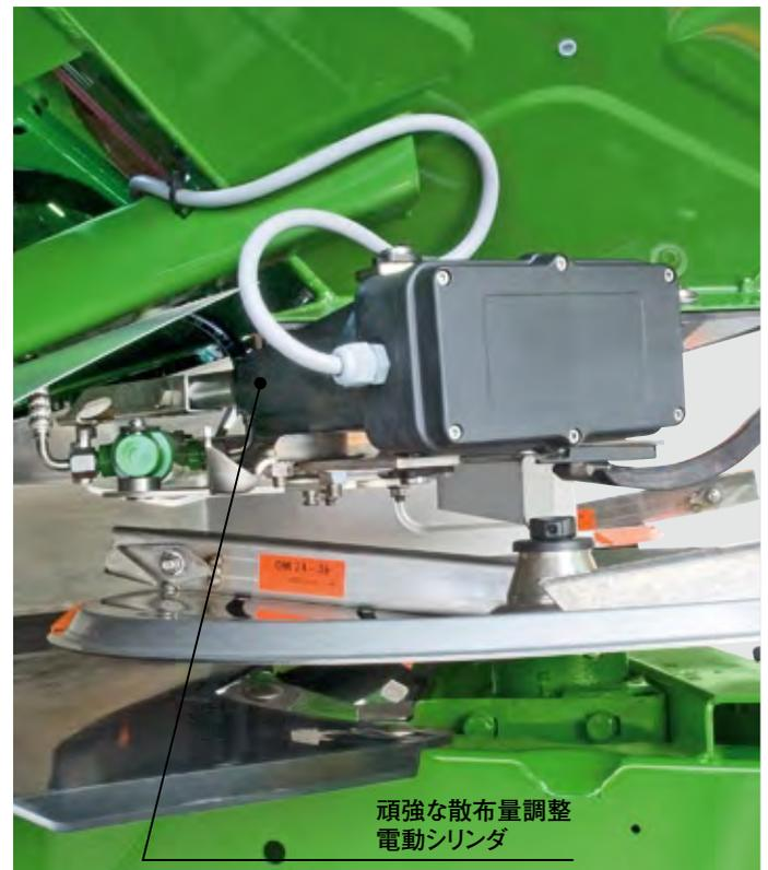
これによりシャッターを開いた瞬間から設定した量の肥料が散布されます。AMADOS+による車速連動散布量制御（オプション）の場合にも散布量調整シャッターだけが希望する散布量の変更や車速の変更に応じて電動シリンダにより制御されます。
