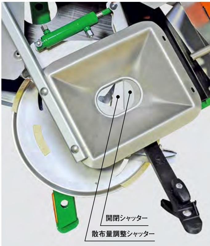
散布量と開閉の2重のシャッター制御システムはそれぞれのシャッターを独立して動かすことができます。複動油圧式の開閉シャッターは枕地などでのすばやい開閉を行うことができます。
