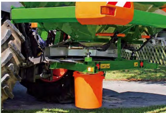
散布量の確認は実際に散布する肥料を測定するキャリブレーションキットを使用することでより簡単に正確に行えます。
