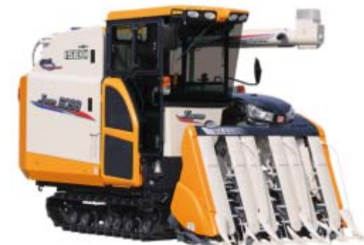
国内向け 収量センサ付コンバイン HJ-Sシリーズ（4条～6条刈）
