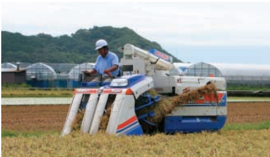
コンバイン フロンティアファイターHF431 (4条刈・31ps)
