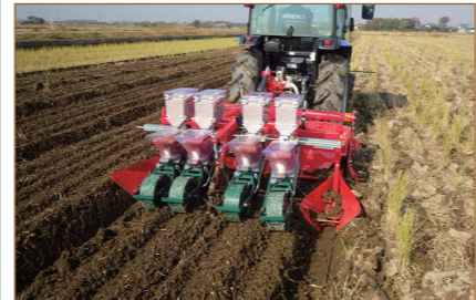
アップカットロータリーによる耕転同時畦立て施肥播種 碎土・畦立て・播種・施肥を同時に行う
