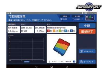
マップデータ連動可変施肥田植機「PRJ-FSJ」
