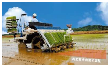
マップデータ連動可変施肥田植機「PRJ-FSJ」
