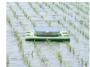
自動抑草ロボット「アイガモロボ」
