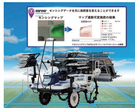
8条植え可変施肥田植機 PRJ-FV型式
