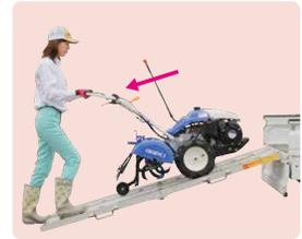
積み込みは「前進1」、積み降ろしは「後進」でエンジン回転を低速まで下げてゆっくり行い、デフ切替レバーがあるものは、必ず「デフ固定/後進」の位置にしてください。
