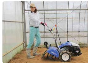
バック時、機械と障害物の間にはさまれる恐れがあるので、必ず後方を確認してください。
