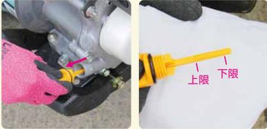
機械を水平にしてから、オイルゲージを抜いて一度オイルをきれいに拭き取り、ねじ込まずに給油口に差し込みます。再度引き抜き、オイルが上限と下限の間にあればOKです。
