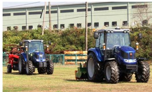
ロボットトラクタデモ（右：無人で走行するトラクタ）
