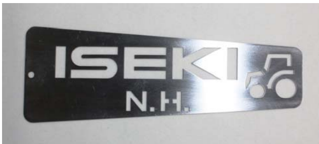
CADによるデザインとレーザー加工によるキーホルダー
