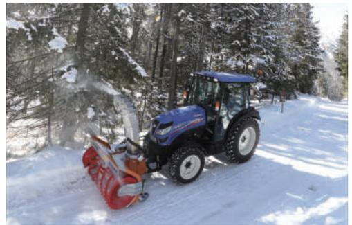
スノーブロワを機体前方に取り付け除雪作業を行うトラクタ
