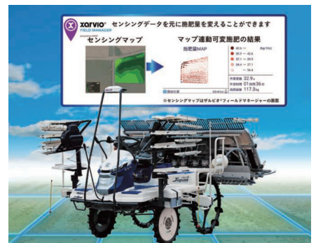
8条植え可変施肥田植機 PRJ-FV型式
