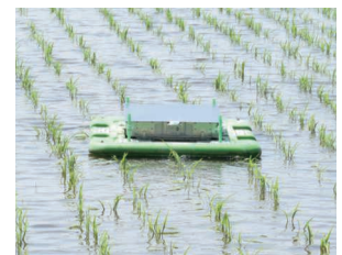
自動抑草ロボット「アイガモロボ」
