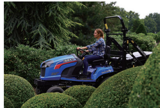
第5次排出ガス規制適合エンジンを搭載した乗用芝刈機
