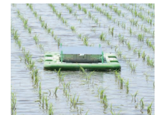
自動抑草ロボット「アイガモロボ」
