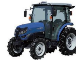
排出ガス規制に対応したエンジンの搭載やGPSによる位置測位とジャイロセンサを用いた車体の傾きを補正するシステムの組み合わせにより、ハンドル操作をせずに自動的に直進走行可能なジアスNTA5直進アシスト仕様を「エコ商品」と認定しました。
