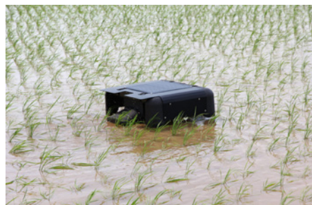
水稻用自動抑草ロボット「アイガモロボ2」
