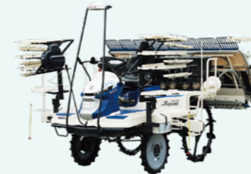
直進・旋回アシスト機能付き田植機 さなえJapan PRJ8
