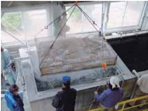
浸種水槽利用型温湯殺菌設備
