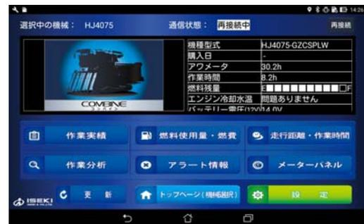
収量コンバインは、水稻の収穫作業と同時に、ほ場毎の籾の収穫量や水分量の計測ができます。ほ場毎の収量等をデータ化することで、収穫後の乾燥・調製工程の作業計画や翌年の施肥設計等の計画を効率的に行えます。
