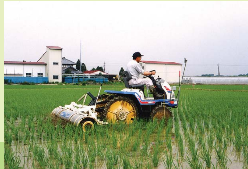
▲2,3回目の作業ではロータを深く入れられるので除草効果は大幅にアップする。
