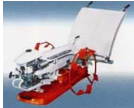
初期の自脱型コンバインと歩行型田植機
